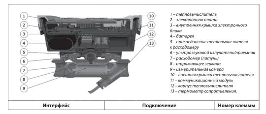
Интерфейсы передачи данных теплосчетчика Теплосчетчик имеет слот для установки коммуникационных модулей:
