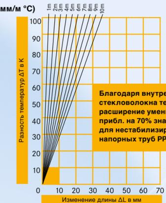
п. 1 – укорочение трубы:  $8 \text{ м} \cdot 7^\circ \cdot 0,035 = 1,96 \text{ мм}$
