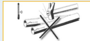
При минусовых температурах существует опасность повреждения труб в результате ударов или падений (так называемый «эффект кнута»). Поэтому при таких низких температурах с материалом следует обращаться особенно осторожно.
