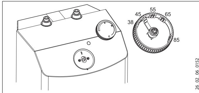
С помощью рычажка, расположенного под ручкой регулятора температуры, можно ограничивать диапазон вращения ручки, т. е. максимальную температуру.
