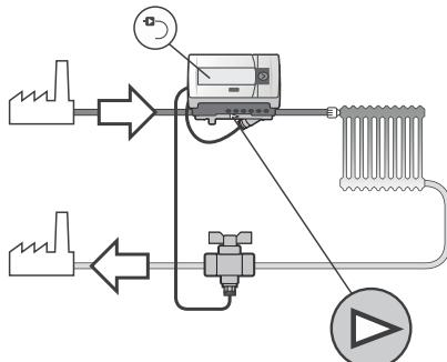
Установка на подающем трубопроводе
