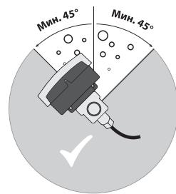
Положение относительно трубы: расходомер должен быть расположен под углом от 45 до 315° во избежание скопления воздуха
