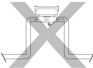
Местоположение на трубопроводе: без ограничений, но следует избегать мест, в которых может скапливаться воздух
