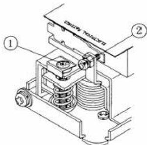
Для настройки предела срабатывания реле протока применяется регулировочный винт 1 (см. Рис. 3.). Вращение винта по часовой стрелке приводит к повышению точки срабатывания, а при вращении против часовой стрелки— к её понижению.
