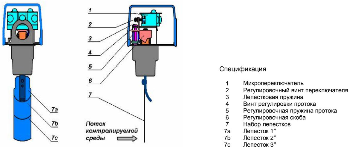
Рис. 2. Устройство индикатора уровня( реле протока) FQS
